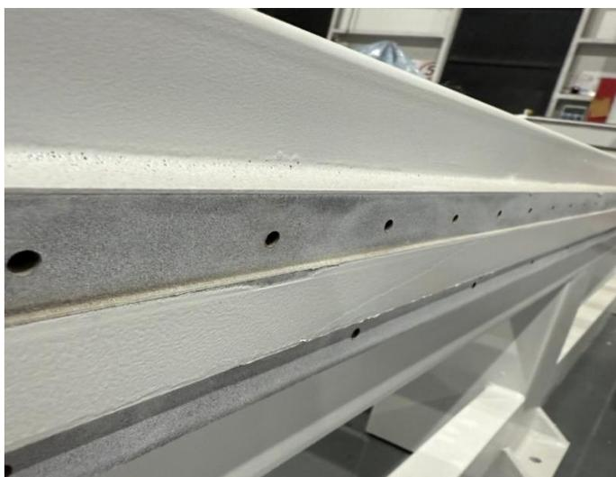
Фрезерование привалочной поверхности производится за один проход, на специальном оборудовании, на этом же этапе производится высокоточное сверление отверстий на коротком расстоянии друг от друга, для жесткой фиксации направляющих и, как следствие, плавного и точного перемещения портала, даже на самых высоких скоростях.
